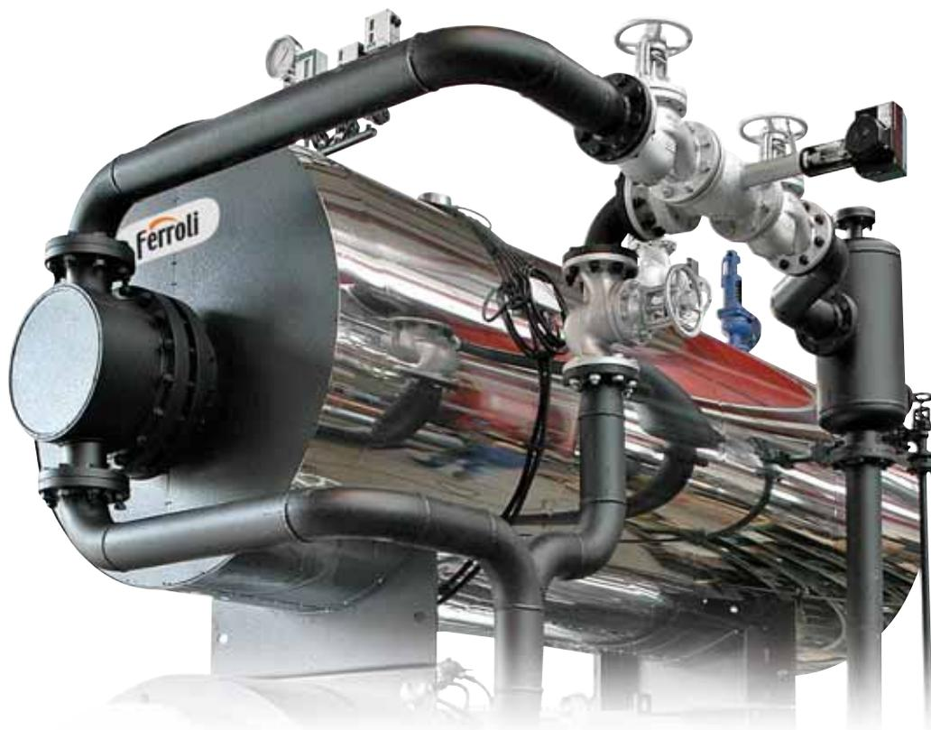
Generador de vapor indirecto por aceite térmico, cuerpo fabricado en acero al carbono; serpentín intercambiador extraíble en forma de "U" hecho acero al carbono o AISI 304. Presión diseño 12 bar; diferentes presiones disponibles bajo pedido. La gama incluye 15 modelos de **166 kg/h** hasta **8.300 kg/h**.
